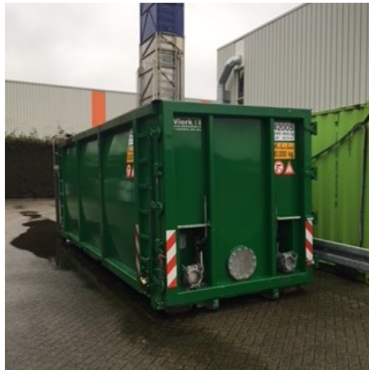
Opvangcontainer was- en spoelwater
